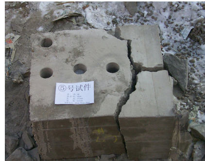
图 6 试块爆破后取芯照片
